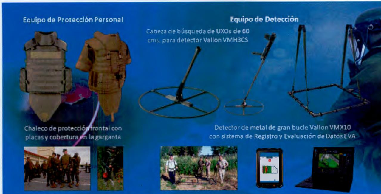
Figura 2. Equipo de protección EOD para limpieza de Áreas Contaminadas con municiones de racimo.
