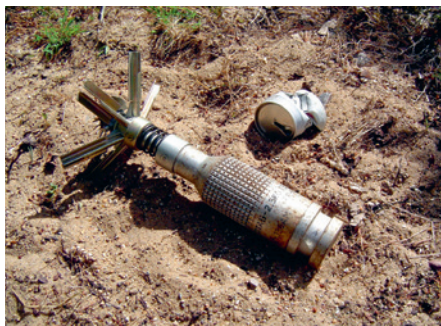
11 – La PTAB-2.5KO russe est une sous-munition à double effet, dans laquelle une charge creuse HEAT est associée à une enveloppe à fragmentation pourvue d'entailles.
