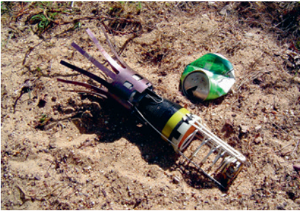
16 – La BL 755 britannique est amorcée par un élément piézoélectrique installé dans le nez. La fusée est dotée de dispositifs de sécurité mécaniques et électriques.
