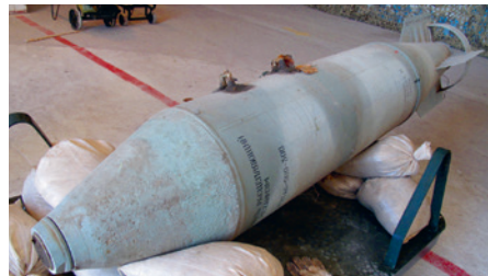
3 – Cet « AGITAB » russe est inspiré d'une bombe à sous-munitions, mais il contient une charge utile de dépliants.
