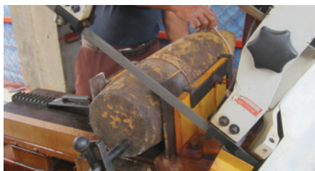
25 – On découpe le projectile pour accéder à l'explosif.
