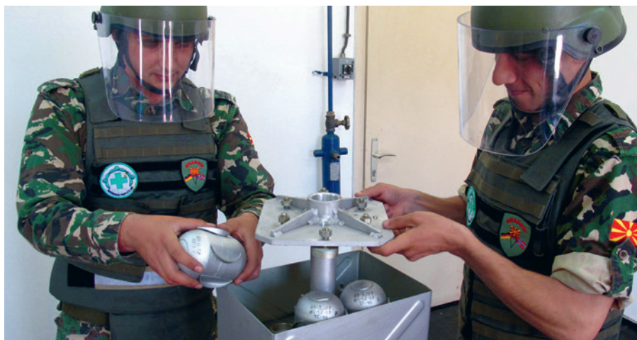
24 – Des opérateurs macédoniens démontent une arme à sous-munitions russe BKF.
