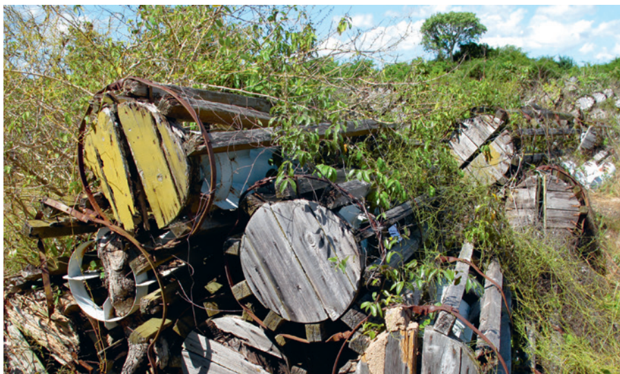
23 – Ces bombes à sous-munitions au Mozambique, stockées à l’extérieur pendant de nombreuses années, se sont détériorées du fait de leur exposition à la pluie et à des températures élevées.
